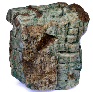
Station 7: Ein »Krebs« entstanden beim Brennen von Kalk
